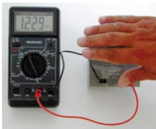
Η αντίσταση ενός LDR αυξάνεται όταν μειώνεται η ένταση του φωτός που προσπίπτει σ' αυτό.
