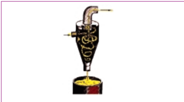
Σχήμα 2.14. Διαχωρισμός στερεών με κυκλώνα.
