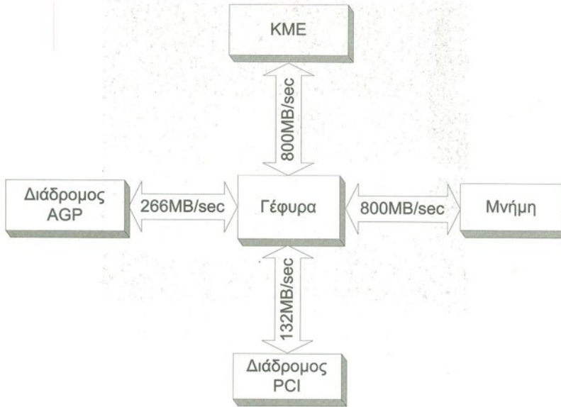
Σχήμα 2.27 Σύνδεση των διαδρόμων ενός σύγχρονου υπολογιστή με τη χρήση γέφυρας
