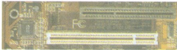
Σχήμα 2.28 Υποδοχή επέκτασης AGP (πάνω) δίπλα από μια υποδοχή επέκτασης PCI
