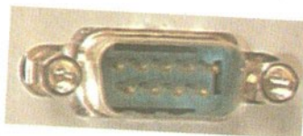
Σχήμα 2.32 Οι υποδοχείς βύσματος της σειριακής θύρας
