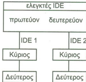
Σχήμα 6.33 Σύνδεση καλωδιωταινίας με ελεγκτή IDE
