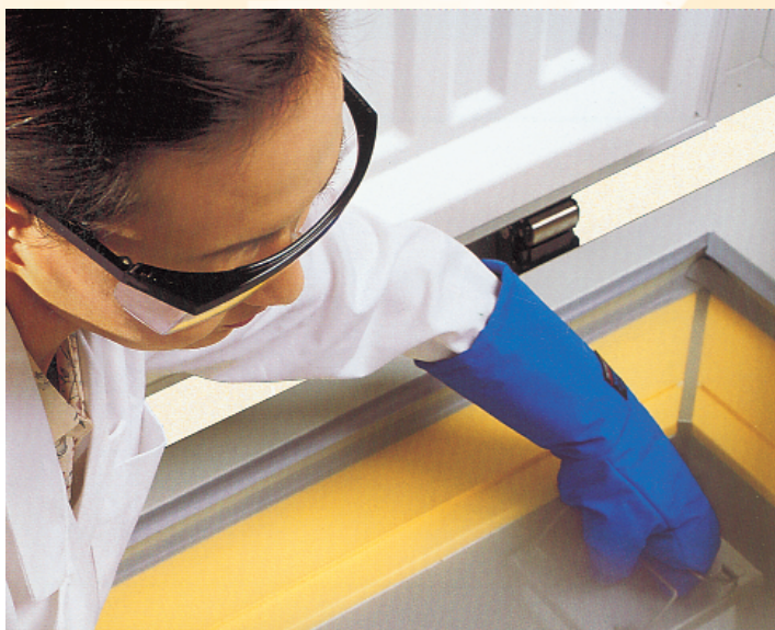
Σχήμα. 11.2. Εργασία στον καταψύκτη οριζόντιου δαπέδου με γάντια, ειδικά γυαλιά και τοποθέτηση των δειγμάτων σε ειδικές θήκες
