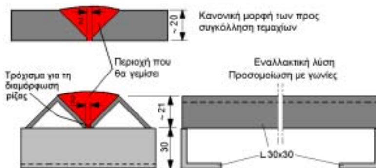
Σχήμα 8.34: Η προετοιμασία και η εκτέλεση της άσκησης – Η προσομοίωση των προς συγκόλληση τεμαχίων με σιδηρογωνίες
