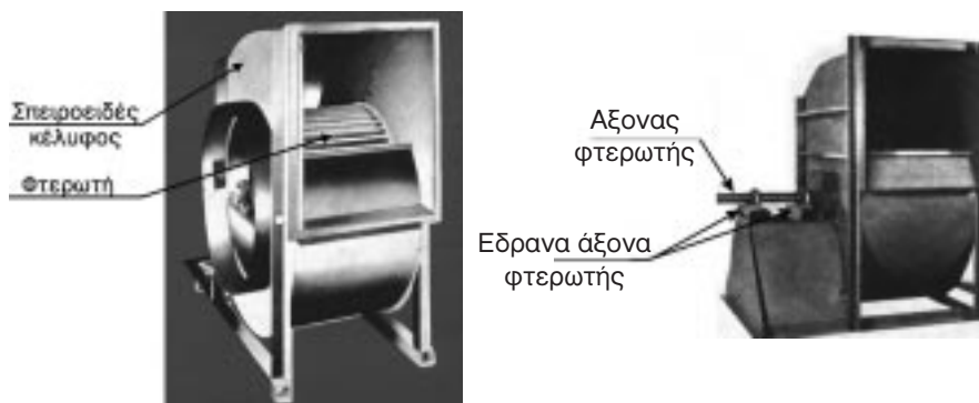
Εικόνα 2.10: Φυγοκεντρικού τύπου ανεμιστήρες.
