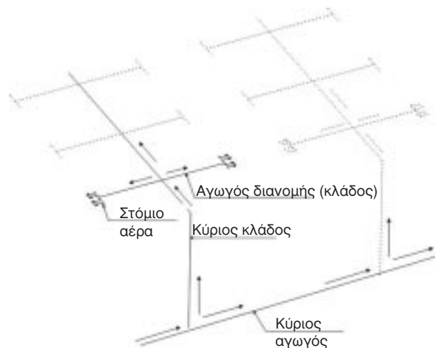
Σχήμα 2.52: Σχηματική παράσταση δικτύου κεντρικής διακλάδωσης.
