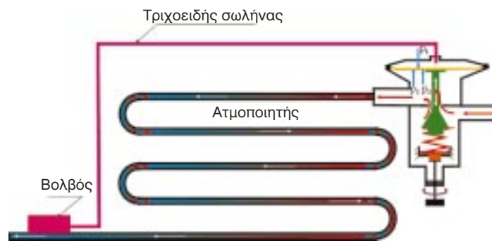
Σχήμα 2.25: Σχηματική παράσταση λειτουργίας θερμοστατικής εκτονωτικής βαλβίδας με εσωτερική εξίσωση της πίεσης.
