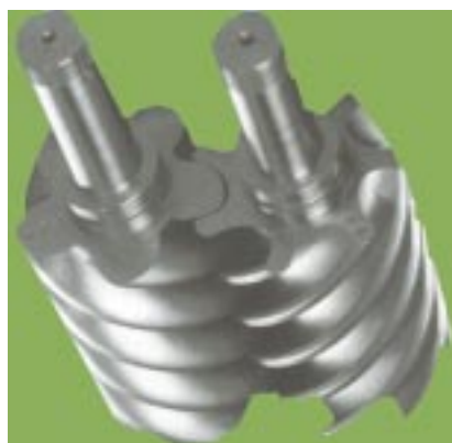
Εικόνα 2.1: Ζεύγος κοχλιόμορφων στροφείων σε συνεργασία.
