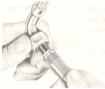
Σχήμα 1.208 Τοποθέτηση προστατευτικού καλύμματος
