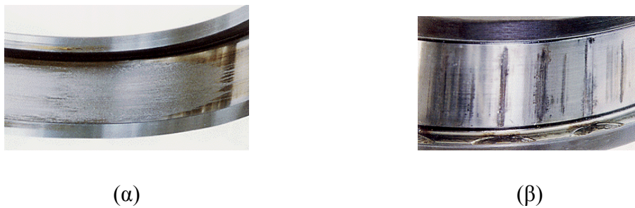
Σχήμα 1.181 (α) Smearing - Θαμπάδα, (β) Wear - Φθορά
