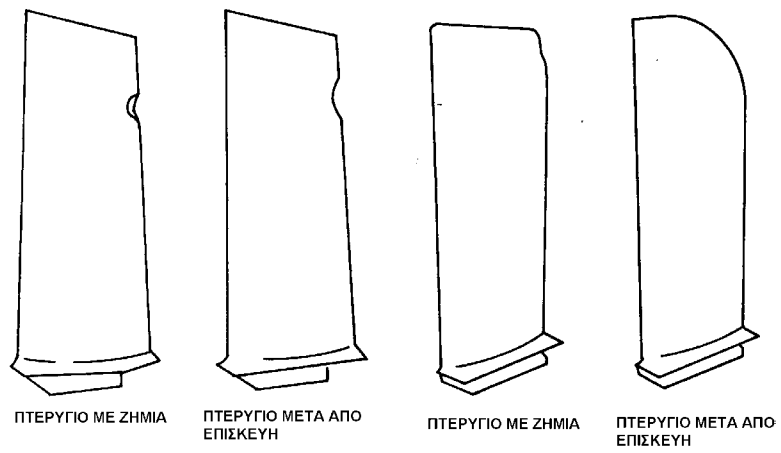
Σχήμα 2.213 Κινητά πτερύγια συμπιεστή πριν και μετά την αποκατάσταση της ζημίας τους
