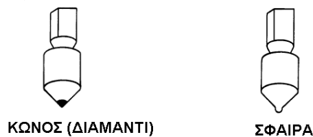
Σχήμα 2.240 Βάσεις δοκιμής και διεισδύτες για τη σκληρομέτρηση Rockwell
