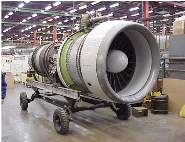
Σχήμα 2.162 Κινητήρας τύπου στροβιλοανεμιστήρα σε κλίνη μεταφοράς
