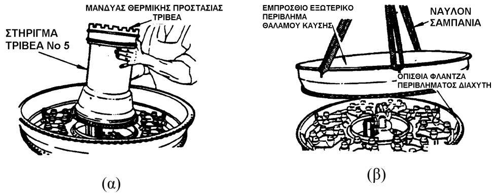
Σχήμα 2.187 Αφαίρεση εξαρτημάτων θαλάμου καύσης
