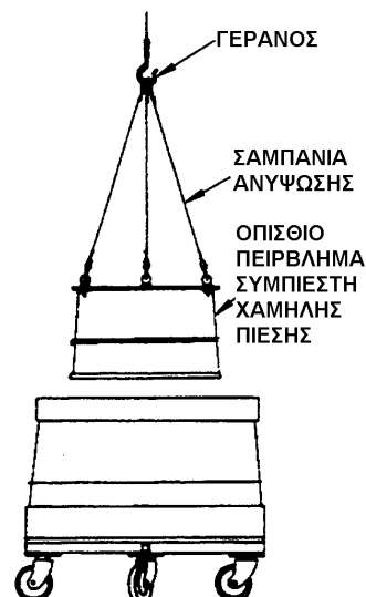
Σχήμα 2.191 Αποσυναρμολόγηση οπίσθιου περιβλήματος συμπιεστή χαμηλής πίεσης
