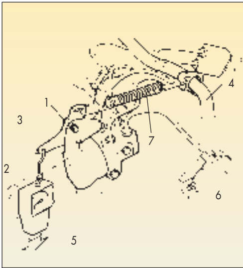
Σχ. 6.30 Κατανεμτής πίεση υδραυλικού συστήματος πέδησης
