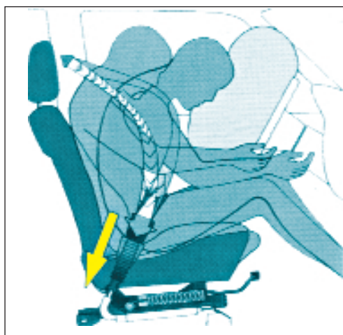
Σχ.9.6 Ζώνη ασφαλείας με σύστημα προεντατήρα και αερόσακο.
