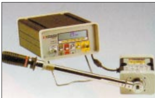
Torque meter Ηλεκτρονικό ροπόμετρο
