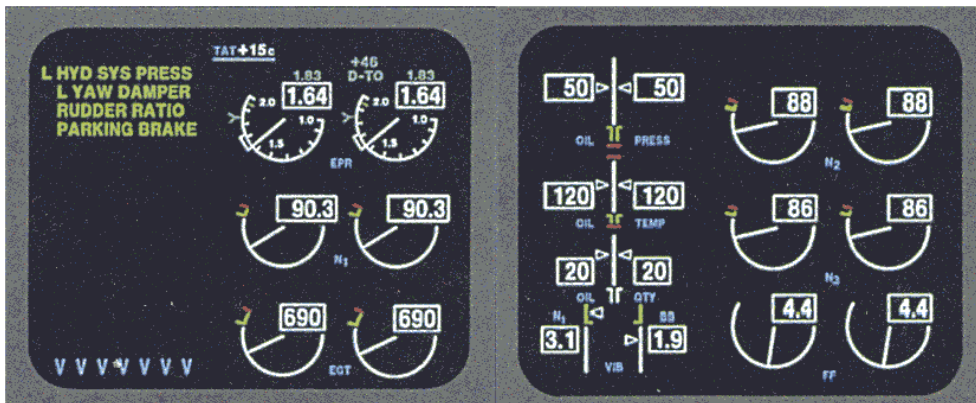
Σχήμα 3.64 Οθόνη πολλαπλών ενδείξεων στοιχείων κινητήρα δικινητήριου αεροσκάφους
