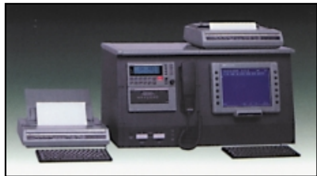
Φωτογραφία 2ε. Κοσόλα επικοινωνίας με Inm-C και ΤΛΦ-ΤΑΠ MF/HF-DSC
