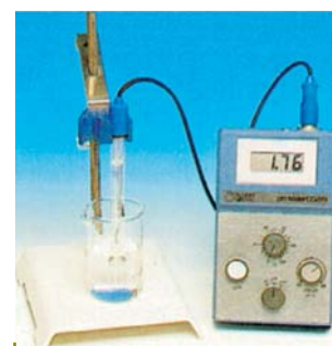
Μέτρηση του pH με τη βοήθεια πεχάμετρου
