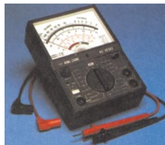
Συνηθισμένο εργαστηριακό πολύμετρο. Μπορεί να μετρήσει τάση, ένταση και αντίσταση.
