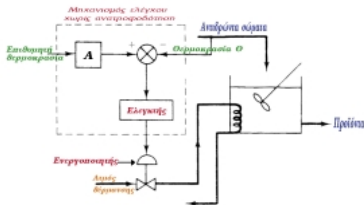
Εικόνα 6.3.5 Έλεγχος θερμοκρασίας ανοικτού χημικού αντιδραστήρα συνεχούς λειτουργίας με σύστημα αυτόματου ελέγχου χωρίς ανατροφοδότηση
