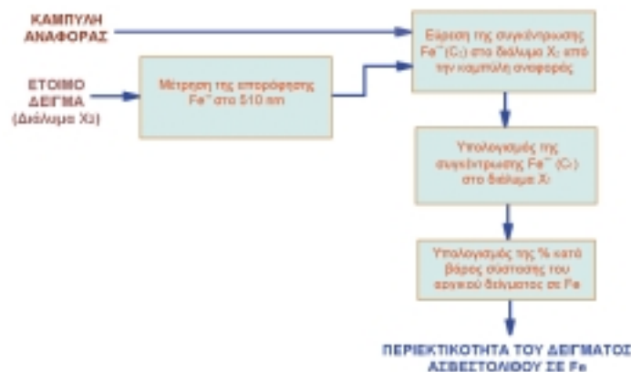
Εικόνα 6.1.5 Μέτρηση της απορρόφησης και υπολογισμός της συγκέντρωσης του σιδήρου στον ασβεστόλιθο (ΣΤΑΔΙΟ 3)
