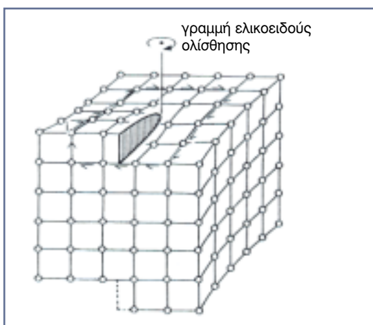
Σχήμα 2.9: Ελικοειδής ολίσθηση σε κυβικό κρύσταλλο.
