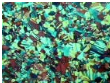
Σχήμα 1.12: Η μορφή των κόκκων κράματος χαλκού, όπως φαίνονται σε μικροσκόπιο
