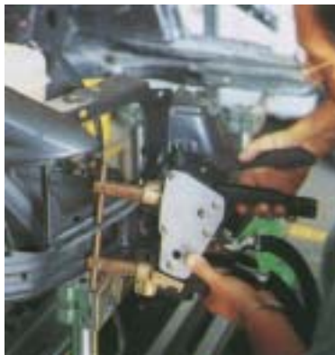
Σχήμα (10.13): Η συγκόλληση με ηλεκτροπόντα χειρός κατά την επισκευή αμαξώματος αυτοκινήτου
