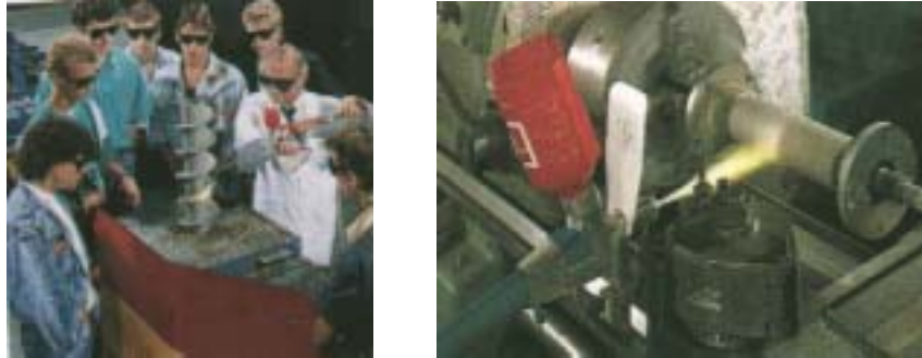
Σχήμα (11.3): (Α) Επίδειξη αναγόμωσης μεταφορικού κοχλία σε σχολικό εργαστήριο με τη μέθοδο ψεκασμού (Β) Διαδικασία αναγόμωσης εξαρτήματος με αυτόματη μηχανή ψεκασμού λιωμένης μεταλλικής σκόνης
