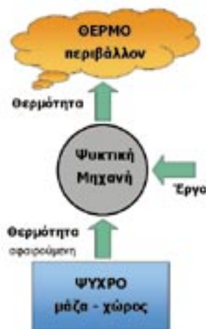
Σχήμα 1.5. Η αρχή λειτουργίας των ψυκτικών διατάξεων
