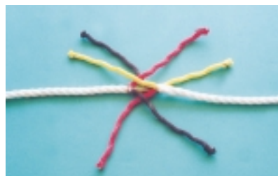
Εικόνα 7.12 (α): Ξεκίνημα κοντοματισιάς
