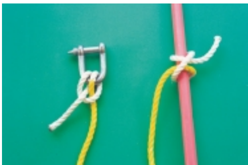
Εικόνα 7.24 (β): Ψαλιδιά. Εδώ φαίνεται και η συνήθης εφαρμογή αυτού του κόμπου.
