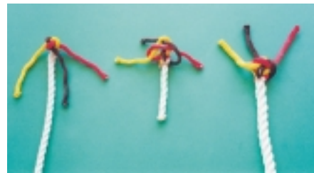
Εικόνα 7.9 (β): Καρυδόκομπος με φανάρι. Τα έμβολα συνεχίζουν να πλέκονται μεταξύ τους σχηματίζοντας έτσι το εξόγκωμα που ονομάζεται «καρύδι» ή φανάρι.
