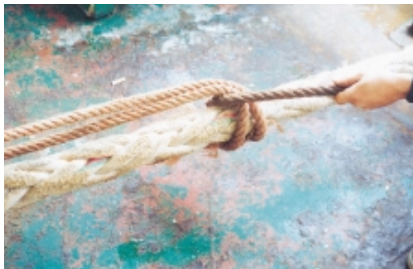
Εικόνα 7.13 (α): Ξεκίνημα απλού μπότσου σε κάβο
