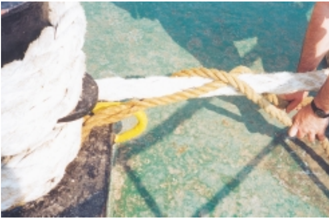
Εικόνα 7.13 (γ): Ξεκίνημα σταυρωτού μπότσου σε κάβο
