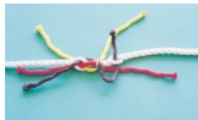
Εικόνα 7.12 (β): Ενδιάμεση πλέξη της κοντοματισιάς
