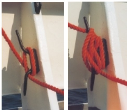
Εικόνα 7.2 (α), (β): Βόλτες σε κοτσανέλο
